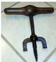
Pour remplir le tonneau ou goûter le vin, il est nécessaire de faire un trou dans la douelle la plus large du tonneau. Le tonnelier utilise soit un vilebrequin **tarière à mèche conique**, soit encore une grosse tarière à tarières sont appelées **bondonnières**. Le **tire-bonde** est utilisé pour sortir la bonde lors du soutirage du vin pendant la vinification.
