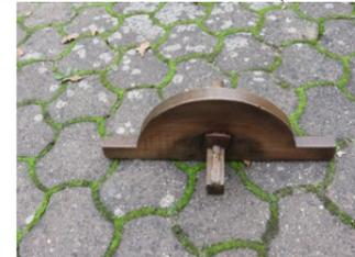
Ainsi va naître le pas d'asse dans lequel sera creusée la rainure, le jable, où viendra s'encaster le fond. L'action de l'asse étant irrégulière en profondeur et en largeur, le tonnelier va utiliser un **rabot stockholm** (qui a une semelle convexe dans la longueur et la largeur) pour régulariser le pas d'asse. A ce stade, il pourra réaliser le jable à l'aide du **jabloir**.
