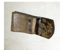
Les racloirs les plus simples sont constitués d'une lame d'acier soit forcée dans un manche en bois : c'est le **guistre** ; soit maintenue entre deux planchettes de bois terminées en poignées cylindriques et associées fermement entre elles par des vis : c'est le **racloir**, à lame droite ou concave, retrouvé dans plusieurs métiers du bois et dont la forme évoque le wastringue.
