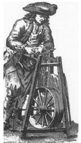
Ensuite viendra le temps de la démultiplication de l'entraînement au moyen d'une grande roue et d'une courroie, des tiroirs pour ranger les outils.
