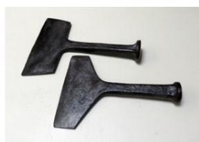
Les bires permettent le bon écoulement de la sève dans le pot. Pour la fixation des bires sur les carres basses on utilisait pour l'entaille un pousse-crampon droit: le '**place-bire**' ou plante-bire.
